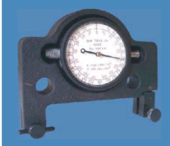
**Bandspannungsmessgerät** (die empfohlene Bandspannung liegt zwischen 25000 und 30000 PSI)
