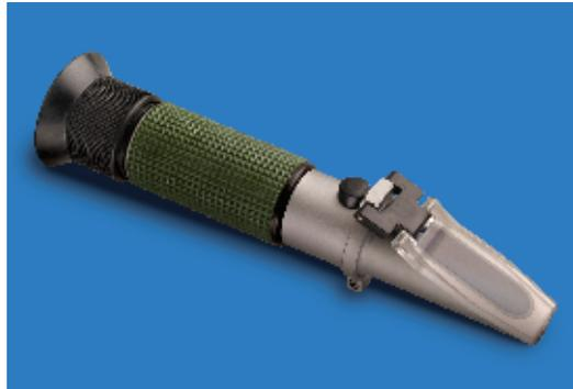
Refraktometer (Die richtige Konzentration des Kühlschmiermittels)
